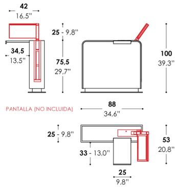
Tótem Técnico autónomo para integrar elementos electrónicos como monitores escamoteables o cajas eléctricas, dando servicio auxiliar a salas de reuniones.
